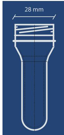
پریفرم با این دهانه پس از تبدیل به بطری برای محصولات گازدار مانند نوشابه و دوغ استفاده می شود. سطح مقطع این محصول و درب آن باعث کنترل بهتر فشار گاز موجود در بطری می شود.
